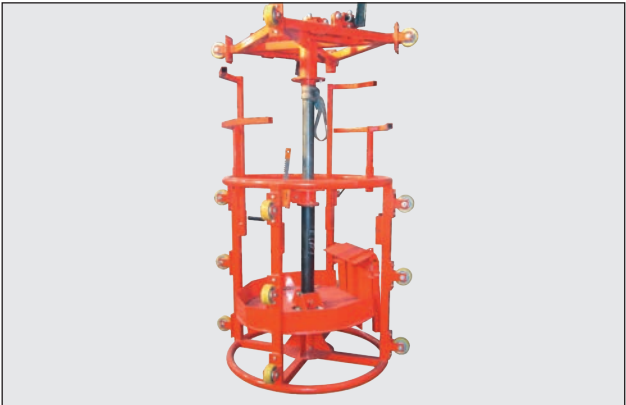
Rohrbefahranlage zum horizontalen Verfahren in einem Abgasrohr für Hochöfen
